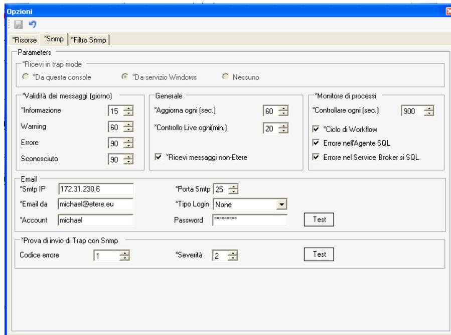
La gestione dei messaggi ricevuti dalla postazione di controllo SNMP è completamente configurabile tramite la creazione di filtri appositi per far sì che solo i messaggi corrispondenti ai parametri specificati vengano comunicati ad un certo operatore:
