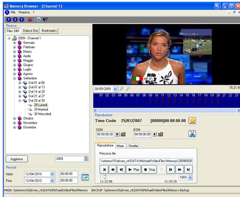
La ricerca dei contenuti avviene singolarmente per ogni canale e permette non solo di visualizzare il materiale registrato ma anche di effettuare diverse funzioni basate nel timecode del materiale come ricerca dei bookmarks, inserimento di bookmarks, esportazione di segmenti video, così come tutte le funzioni standard di playback.
