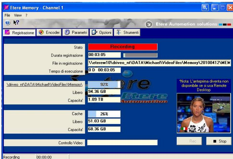
La registrazione avviene tramite file separati di lunghezza configurabile parzialmente sovrapposti per un intervallo configurabile.
